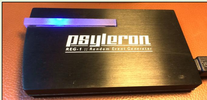
Das **PSYLERON** ist ein Zufallszahlengenerator. Es misst Fluktuationen, die auf Quantenprozessen beruhen. Diese werden durch quantum-tunneling in binäre Ergebnisse – 0 oder 1 – umgewandelt. Dies geschieht 10 mal je Sekunde und kann als Kurve dargestellt werden.
